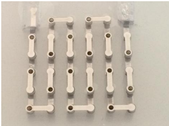
TEG-Prototype flexible (1,5x1.5 cm) basé sur un substrat de PDMS avec 34 cellules connectés en série.
