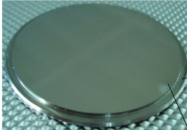
Insert (2mm Wandstärke, D=45mm)
