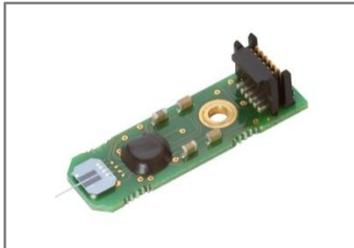
Mikrokraftsensor / Mikrogreifer
