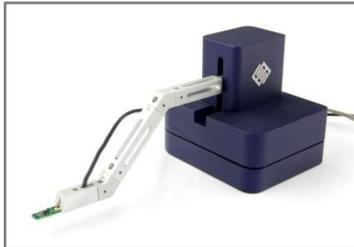
Piezoelektrische Manipulationseinheit mit Positionscodern
